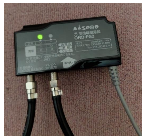
光受信機電源部
